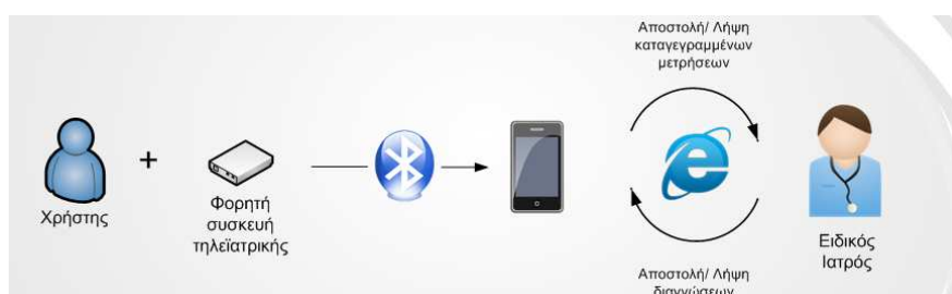
Σχήμα : Λογικό διάγραμμα λειτουργίας συστήματος τηλεματικής παρακολούθησης ατόμου
